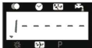
LA VANNE AVANCE AU CYCLE 1 LE CHIFFRE 1 CLIGNOTE
