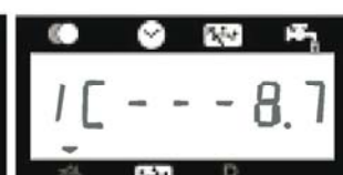
POUR LES VANNES AVEC CHLORINATEUR LA LETTRE C INDIQUE SON FONCTIONNEMENT
